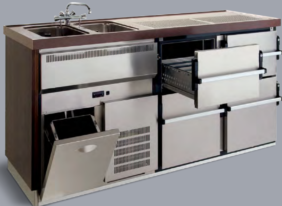
Beispielhafte Ausführung mit zwei Becken und Abfallkipper, einer Abdeckung aus Mineralwerkstoff und zwei Kühlabteilen mit je zwei Rollenausügen, Aufteilung je oben 1/3 und unten 2/3.
